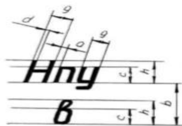
Вспомогательная сетка и параметры шрифта по ГОСТ 2.304-81
