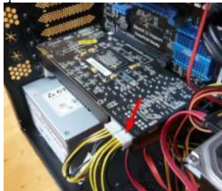
Рисунок 12 - Разъемы блока питания для подключения видеокарт
