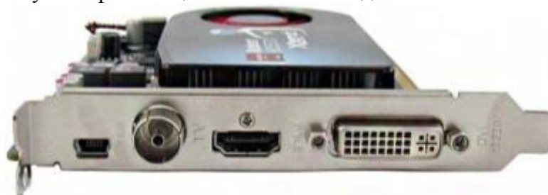
Рисунок 4 - Видеокарта с однослотовой системой охлаждения
