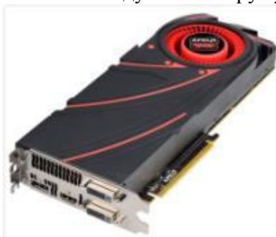
Рисунок 6 - Видеокарта с референсной турбинной системой охлаждения
