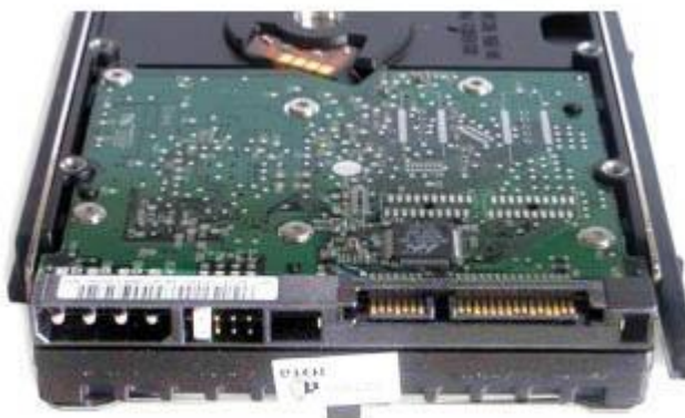
Рисунок 11 - старый 4-х контактный Molex и новый 15-ти контактный разъем питания стандарта SATA
