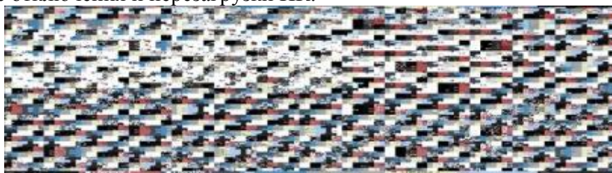
Рисунок 15 – Признаки неисправности видеокарты
