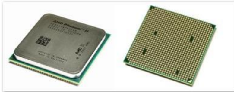
Рисунок 2 - Процессор AMD (с классическими ножками)
