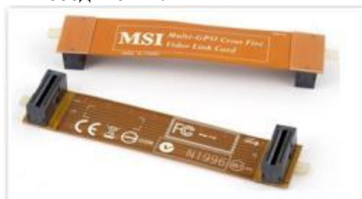
Рисунок 13 - Шлейфы для соединения видеокарт между собой
