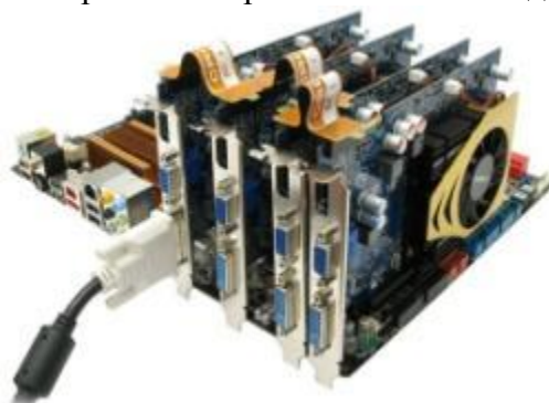
Рисунок 14 - Соединение нескольких видеокарт
