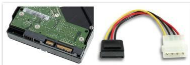
Рисунок 12 – Переходник с 4-х контактного разъема Molex
