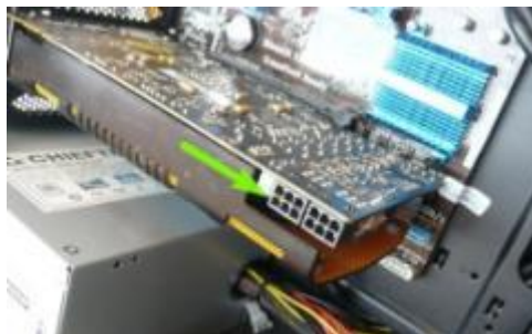
Рисунок 11 - Современные разъемы дополнительного питания мощной видеокарты
