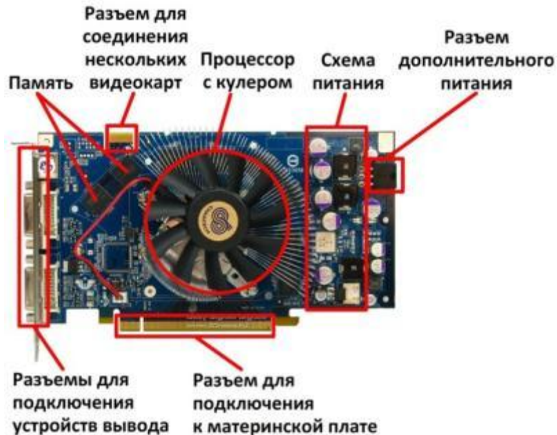
Рисунок 1 – Компоненты видеокарты
