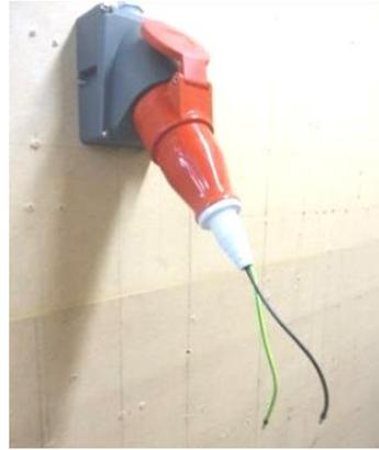
Подготовленные разъёмы соединяется с соответствующими разъёмами ЭУ. К полученным проводникам подключаются электроды мегомметра.
